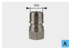
Штекер : IG. Нерж. сталь. Макс. 250 bar / 150 °C
