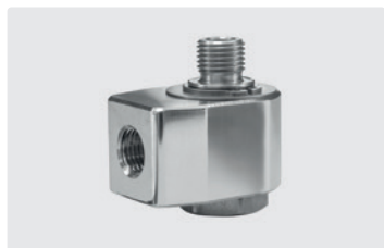
1/4" IG : 1/4" AG. DN 7. Макс. 150 bar / 30 об/мин / 90 °C
