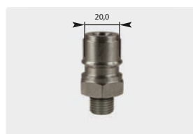
Штекер : AG. Закаленная нерж. сталь. Макс. 250 bar / 150 °C
