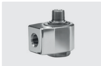
1/4" IG : 1/4" AG. DN 7. Макс. 275 bar / 30 об/мин / 120 °C
