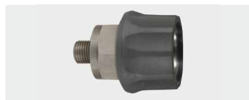
Муфта : AG. Нерж. сталь. Макс. 600 bar / 150 °C
