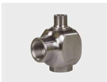
1/2" IG : 3/8" AG. DN 10. Макс. 300 bar / 30 об/мин / 90 °C
