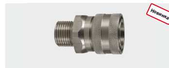
Муфта : AG. Нерж. сталь. 60° упл. конус. Макс. 250 bar / 150 °C
