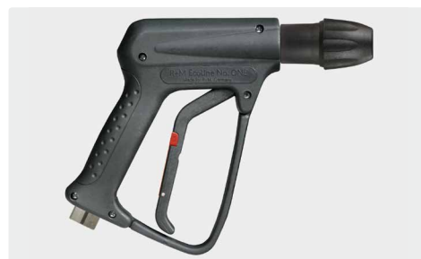
Проф. пистолет R+M EcoLine No. ONE с муфтой KW. Макс. 250 bar / 45 л/мин / 150 °C
