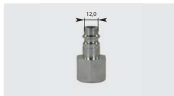
Штекер : IG. Ø 12 мм. Закаленная сталь, химически никелирована/ оцикована. Макс. 200 bar / 100 °C
