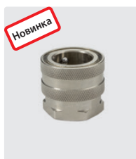
ST-45. Никелированная латунь. Муфта : 3/4" IG. 25 bar / 90° C
