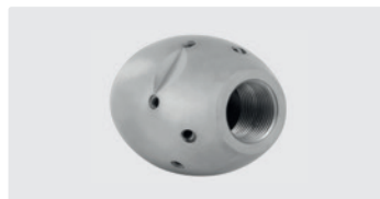
1/2" IG. 6x 75° 3x 30° +1x 0°. 80-140 л/мин. Для R 120-250 мм. Наружный Ø 40 мм. 281 г.
