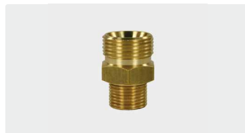
M22 AG : AG с конусом (AGR). Латунь. Макс. 400 bar
