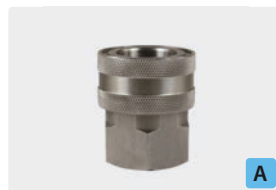
Муфта : IG. Нерж. сталь. Макс. 250 bar / 150 °C
