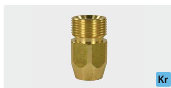
M22 AG : IG. Латунь. Изнутри шестигр. Макс. 400 bar
