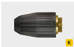
M18 IG. Угол распыления 20°. 200 - 350 bar. Макс. 100 °C
