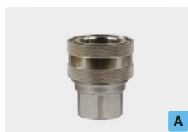
Муфта : IG. Никелир. латунь. Макс. 250 bar / 150 °C
