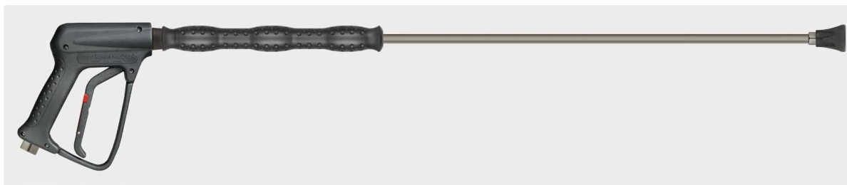
Профес. пистолет R+M EcoLine No. ONE с копьём 900 мм из оцинк. стали, изоляцией ST-28 Cool & Compact 300 мм и защитой форсунки ST-10 без форсунки. Макс. 250 bar / 45 л/мин / 150 °C
