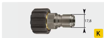
Штекер : IG. Нерж. сталь + латунь. Макс. 250 bar / 150 °C
