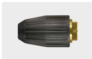
1/4" IG. Угол распыления 20°. 200 - 350 bar. Макс. 100 °C
