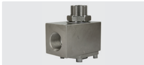
3/4" IG : 3/4" AG. DN 19. Корпус и ось из нерж. стали. Макс. 200 bar / 90 °C
