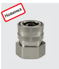
ST-45. Никелированная латунь. Муфта : 1" IG. 25 bar / 90° C
