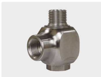
1/2" IG : 1/2" AG. DN 12. Макс. 300 bar / 30 об/мин / 90 °C
