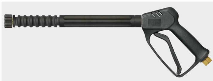
Профес. пистолет с удлинителем 340 мм и HV M22. Макс. 210 bar / 25 л/мин / 150 °C
