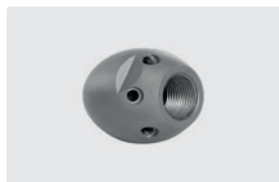
1/4" IG. 6x 75° +1x 0°. 20-50 л/мин. Для R 50-100 мм. Наружный Ø 30 мм. 127 г.
