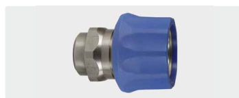
Муфта : IG. Нерж. сталь. Макс. 250 bar / 150 °C
