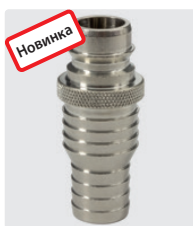
ST-45. Никелированная латунь. Ниппель с наконечником для шланга 19-25 мм. 25 bar / 90° C
