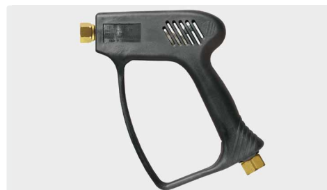
Профес. пистолет без вентиля (свободный поток). Макс. 275 bar / 45 л/мин / 150 °C
