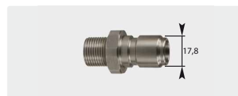
Штекер : AG. Нерж. сталь. 60° упл. конус. Макс. 250 bar / 150 °C
