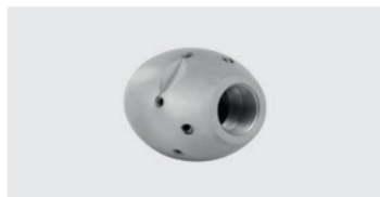
3/8" IG. 6x 75° 3x 30° +1x 0°. 30-100 л/мин. Для R 100-200 мм. Наружный Ø 35 мм. 207 г.
