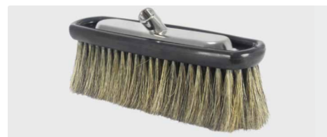
A= 260. B= 230 x 80 мм. Свиная щетина. Держатель из нерж. стали. Макс. 50 °C
