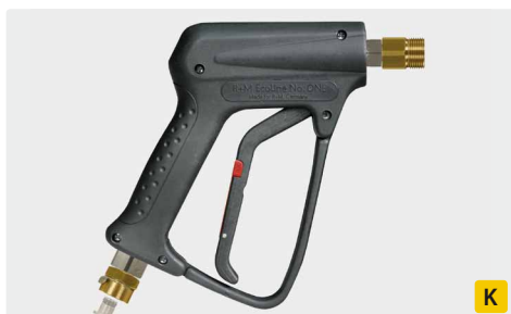
Профес. пистолет R+M EcoLine No. ONE. Макс. 250 bar / 45 л/мин / 150 °C
