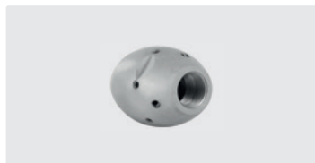
1/4" IG. 6x 75° 3x 30° +1x 0°. 25-70 л/мин. Для R 75-150 мм. Наружный Ø 30 мм. 127 г.
