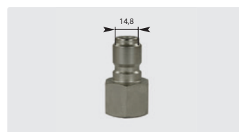
Штекер : IG. Ø 14,8 мм. Оцинк. сталь. Макс. 250 bar / 100 °C
