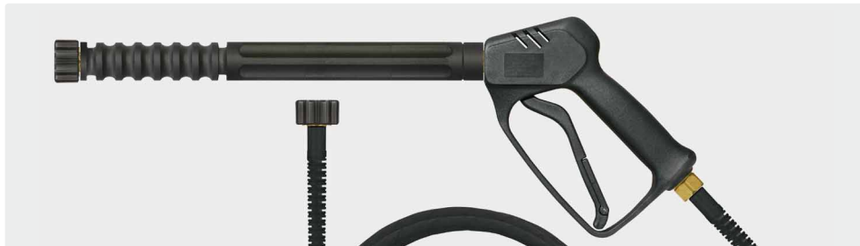
Пистолет с удлинителем 340 мм, макс. 210 bar / 25 л/мин / 150 °C. Вход / Выход HV M22. Шланг: 6 - 160 с 1 тканевой оплеткой, макс. 160 bar / 20 °C
