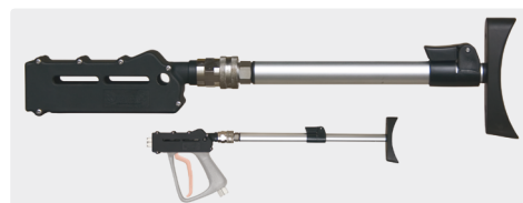
Плечевые опоры ST-3900. Новые нормы ЕС предписывают в обязательном порядке применение плечевой опоры во время проведения работ при отталкивающей силе более чем 150 N. Плавно регулируемая плечевая опора. Вращ. муфта. Подходит для всех пистолетов ST-3600 / ST-3500.
