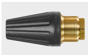
1/2" IG. Угол распыления 20°. 120 - 250 bar. Макс. 100 °C
