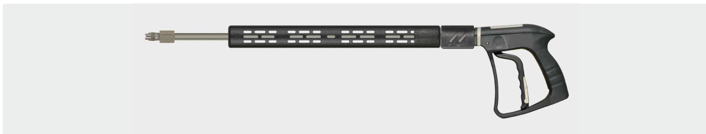
Профес. пистолет для пара с копьём из нерж. стали, изоляцией ST-9 380 мм и форсункой для пара низкого давления из нерж. стали. Макс. 20 bar / 200 °C
