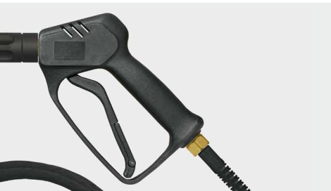
Пистолет с удлинителем 340 мм, макс. 210 bar / 25 л/мин / 150 °C. Вход / Выход HV M22. Шланг: Flexy с 1 проволоочной оплеткой, макс. 300 bar / 100 °C
