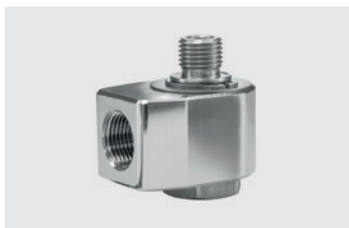
3/8" IG : 1/4" AG. DN 7. Макс. 150 bar / 30 об/мин / 90 °C
