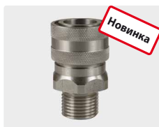
Муфта : AG. Нерж. сталь. 60° упл. конус. Макс. 250 bar / 150 °C
