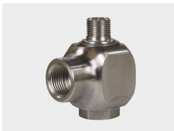
1/2" IG : 3/8" AG. DN 10. Макс. 300 bar / 30 об/мин / 90 °C
