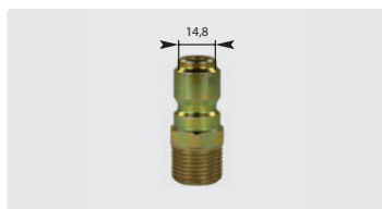
Штекер : AG. Ø 14,8 мм. Оцинк. сталь. Макс. 250 bar / 100 °C
