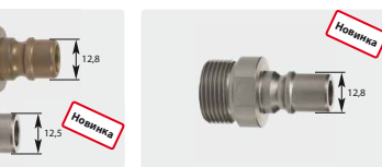
Штекер : IG. Закаленная нержавеющая сталь. Макс. 350 bar / 100 °C
