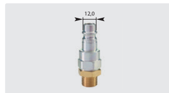
Штекер : AG. Ø 12 мм. Закаленная сталь, химически никелирована/ оцикована и латунь. Макс. 200 bar / 100 °C
