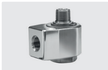
1/4" IG : 1/4" AG. DN 7. Макс. 275 bar / 30 об/мин / 120 °C
