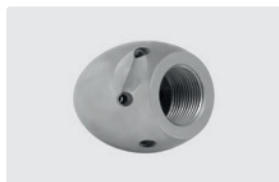
1/2" IG. 6x 75° +1x 0°. 30-100 л/мин. Для R 100-200 мм. Наружный Ø 40 мм. 281 г.
