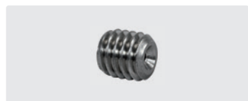
Полная струя 500 bar. Закаленная нерж. сталь Внутренний шестигранник 2,5мм
