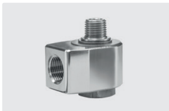
3/8" IG : 1/4" AG. DN 7. Макс. 275 bar / 30 об/мин / 120 °C
