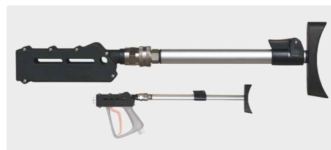
Плечевые опоры ST-3900. Новые нормы ЕС предписывают в обязательном порядке применение плечевой опоры во время проведения работ при отталкивающей силе более чем 150 N. Плавное регулируемая плечевая опора. Вращ. муфта. Подходит для всех пистолетов ST-3600 / ST-3500.
