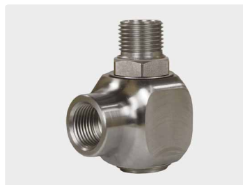
1/2" IG : 1/2" AG. DN 12. Макс. 300 bar / 30 об/мин / 90 °C
